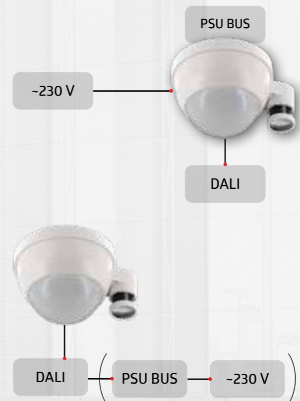
DALI-Melder können entweder BUS-betrieben sein oder sie müssen mit 230 V versorgt werden. In letzteren Fall ist meistens die BUS-Spannungsversorgung (PSU BUS) bereits integriert.
