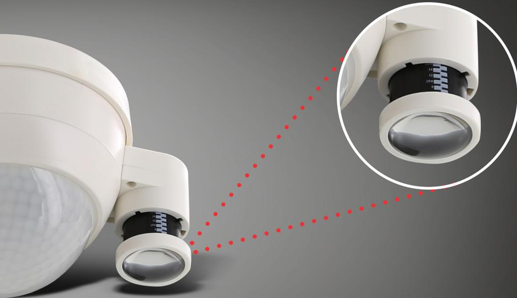
Il sensore di luce telescopico viene estratto in base all'altezza di montaggio di modo che venga evitata ampiamente la fastidiosa incidenza della luce dalla parte della scaffalatura. Ciò consente una regolazione in base alla luce diurna di fino a 16 m di altezza.
