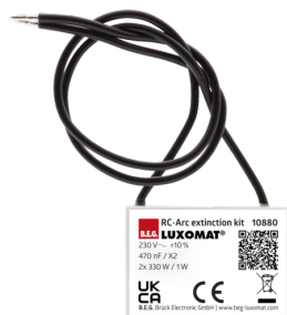
RC-Filtre Anti-Arc Ref.: 10880
