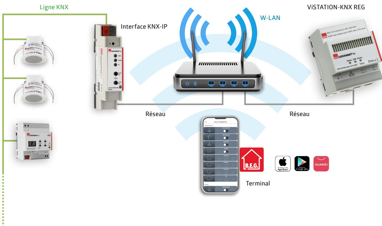
La ViSTATION B.E.G. n'est pas raccordée au bus KNX, mais intégrée au réseau du bâtiment en tant que serveur via LAN. La connexion au système KNX est alors réalisée via une interface IP. Les composants KNX qui doivent être commandés par la visualisation sont reliés comme d'habitude à un système via le bus KNX.
