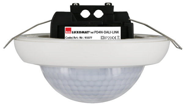
Foto: B.E.G. Brück Electronic GmbH Mit einem zusätzlichen außenliegenden Lichtsensor ermöglicht der PD4N-DALI-LINK eine präzise Messung, auch in schwierigen Lichtsituationen.
