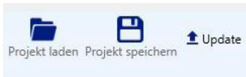
Klicken Sie auf "**Update**", um die Firmware des aktuell ausgewählten KNX-Geräts über den KNX-Bus zu aktualisieren. Diese Funktion unterstützt alle B.E.G. DALI KNX Gateways. Die Aktualisierungsdatei hat das Format **\*.beg** und wird vom Hersteller bereitgestellt.
