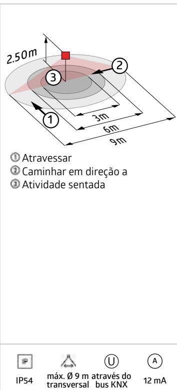
IP54      máx. Ø 9 m através do transversal bus KNX      12 mA
