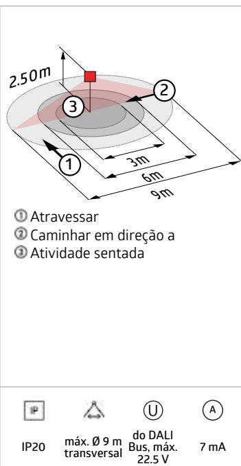
IP20 máx. Ø 9 m transversal do DALI Bus, máx. 22 V 7 mA
