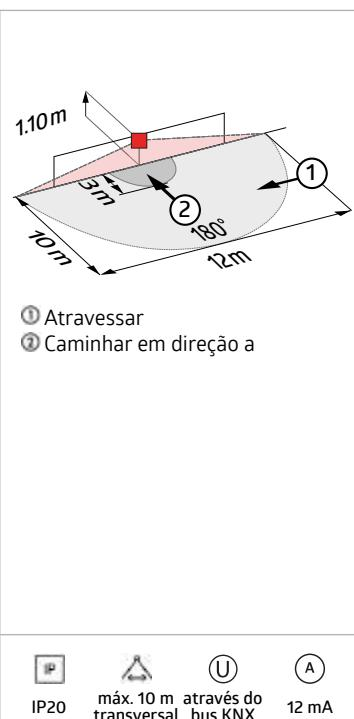
IP20      máx. 10 m através do transversal bus KNX      12 mA
