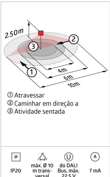
IP20 máx. Ø 10 m transversal do DALI Bus, máx. 22.5 V 7 mA
